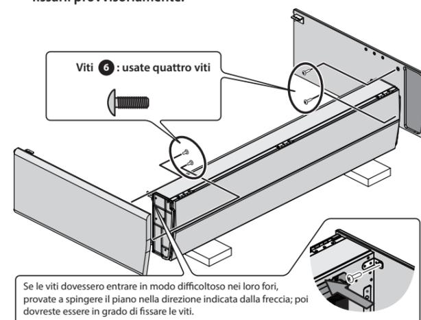
6. Montate la tavola posteriore (4) ai pannelli laterali, e usate le viti (7) per fissarla provvisoriamente.
