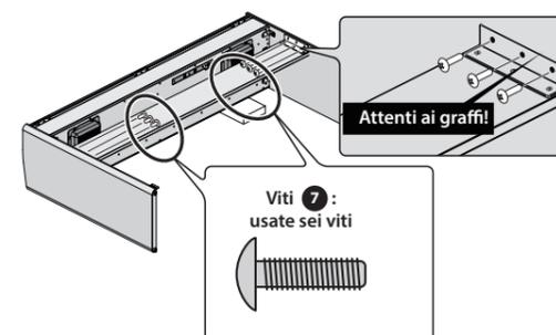
7. Posizionate l'unità in verticale, e montate gli stabilizzatori ai pannelli laterali.
